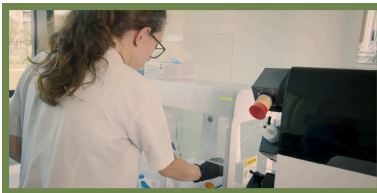
Този тип масспектрометрия (ICP-MS) използва индуктивно свързана плазма, която атомизира и йонизира пробата, за да открие количества метали или неметали в диапазона от части на трилион.
